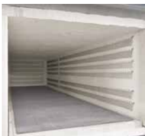
Aislamiento de fibra y resistencias en forma curvada para acortar tiempos de proceso
