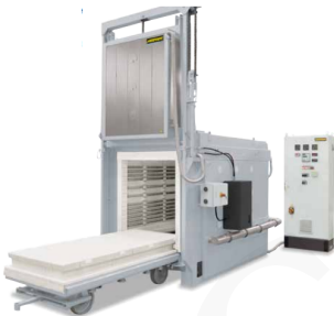
Horno de vagoneta W 2060/S sin calefacción en la vagoneta para el precalentamiento de moldes de fusión
