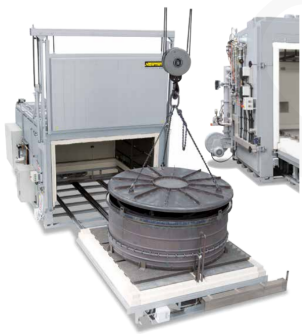
Horno de vagoneta con aire circulación de aire W 5290/85 AS con caja de recocido para tratamiento térmico de bobinas bajo gas protector
