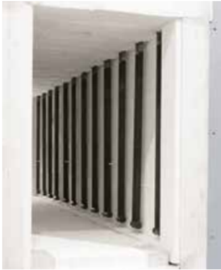
Elementos calefactores de SiC en ambos laterales del horno de vagoneta
