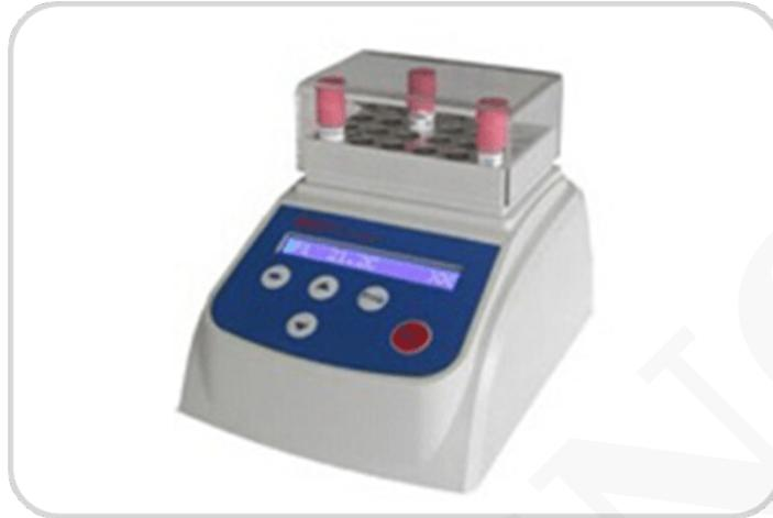
El Incubador de indicador biológico está diseñado para la incubación de temperatura bajo los indicadores biológicos EO. Esto provee una sencilla verificación de la temperatura de incubación.
