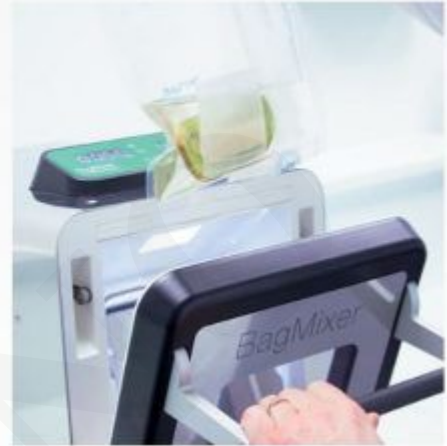
3. Homogeneizar el instaBAG con el BagMixer
