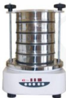
Admite una gran capacidad de carga. Diseñada para admitir hasta 4 tamices de  $\varnothing$  400 mm aunque puede admitir también diámetros inferiores. Con el tamizado 3D, de gran eficacia, se consiguen tiempos de tamizado cortos incluso con grandes muestras de producto. Como el resto de modelos incluye control digital de potencia, tiempo e intermitencia de tamizado. Se puede elegir el sistema estándar de sujeción o el sistema rápido "Easy-Press".
