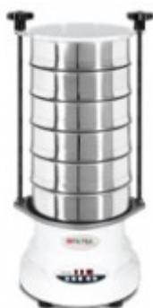
Concebida para volúmenes de muestra grandes, puede admitir 5 tamices de 80 mm o 8 tamices de 50 mm de altura. Los diámetros van de 250 a 305 mm.
