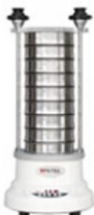
**Tamizadora electromagnética digital** para tamices de  $\varnothing$  60 a 203 mm. Su movimiento tridimensional en toda la columna de tamices la hace muy eficaz a la hora de realizar ensayos granulométricos.
