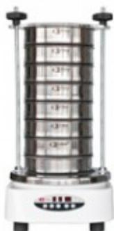
Pequeña, compacta y ligera, es la alternativa económica de la gama de **Tamizadoras electromagnéticas IRIS**. Admite tamices de  $\varnothing$  60 a 203 mm. Hasta 7 tamices de 50 mm o 14 tamices de 25 mm de altura. Incluye control digital de potencia, tiempo e intermitencia de tamizado. Se suministra con el sistema estándar de sujeción.
