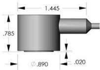
ISR3 - Sensor AE intrínsecamente seguro de 30 kHz con cable coaxial integral
