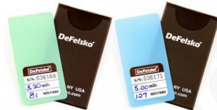
Se utiliza para verificar la precisión y el funcionamiento de PosiTector RTR y otros lectores de cinta de réplica micrométrica de resorte.
