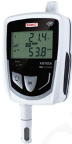
Este registrador de datos inalámbrico de humedad y temperatura KH 210 RF viene con o sin pantalla de 2 líneas. Tiene 20,000 puntos de medición.
