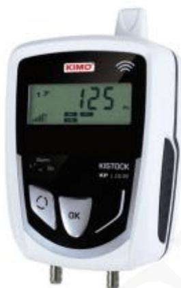
Este registrador de datos de presión inalámbrico KP 111- RF viene con o sin una pantalla de 1 línea. Tiene 12,000 puntos de medición y un rango de presión de -10000 Pa a 10000 Pa.
