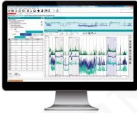
El LDS 300 de Kimo es un software de procesamiento de datos opcional diseñado para dosímetros de ruido.
