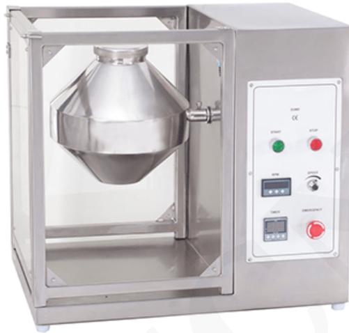
La licuadora doble se puede conectar y desconectar fácil y rápidamente al accionamiento principal de la máquina con la ayuda de un tornillo de bloqueo y desbloqueo rápido y cuenta con un motor monofásico de 0,25 HP, 230 V / 110 V, 50 Hz / 60Hz con ACVF DRIVE instalado.
