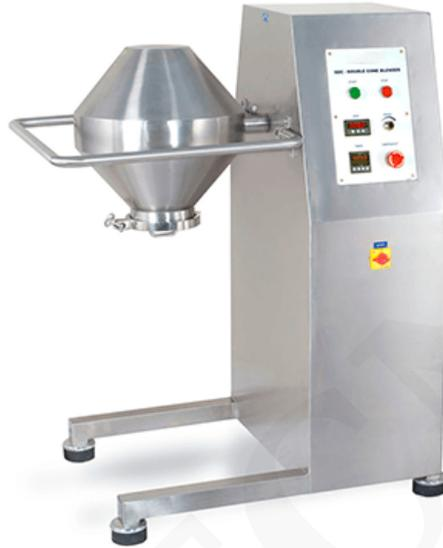
La batidora de doble cono se utiliza para producir una mezcla sólido-sólido homogénea. La mezcla es un paso del proceso común en la fabricación de productos para industrias como la salud, la alimentación, la química, la cosmética, los detergentes, los fertilizantes y los plásticos.
