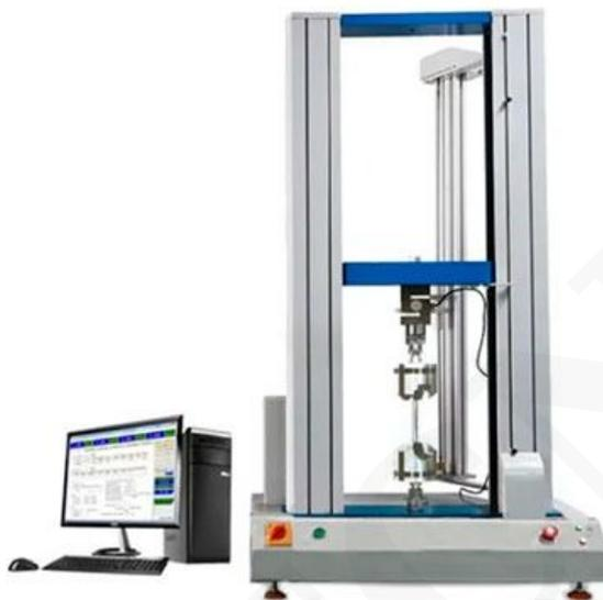
La máquina de prueba de tracción es una de las máquinas de prueba universales con una fuerza máxima de 20KN. En realidad, esta capacidad de prueba puede cumplir con muchos estándares de prueba de materiales además del material de la serie de metal.
