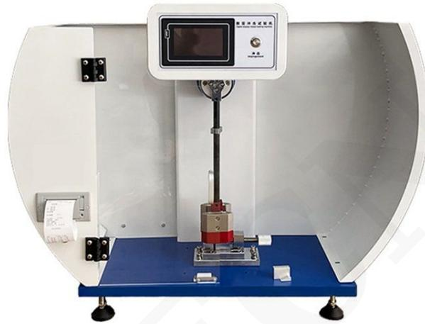
Esta serie de máquinas de prueba de impacto con pantalla digital es un control de microcomputadora de un solo chip, liberación de bloque de martillo eléctrico, visualización de energía de impacto por la pantalla LCD
