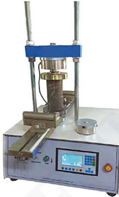
El dispositivo consta de 2 columnas rígidas, una base de hierro fundido con caja de cambios en el interior y un puente de acero para sujetar la celda de carga y los accesorios.
