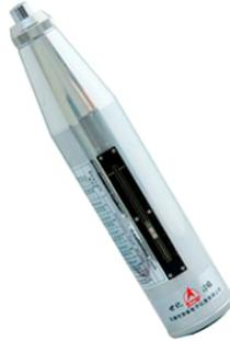
Sometido al estándar de GB/T50315-2000, el instrumento se aplica para probar materiales ligeros como ladrillos, hormigón ligero, etc.
