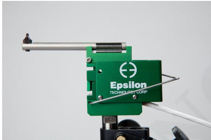
Ampliamente utilizado para medir deformaciones en pruebas de doblez de tres y cuatro puntos, pruebas de compresión y una variedad de deformaciones de uso general. Estos dispositivos de galgas extensométricas vienen con una base magnética para un fácil montaje.
