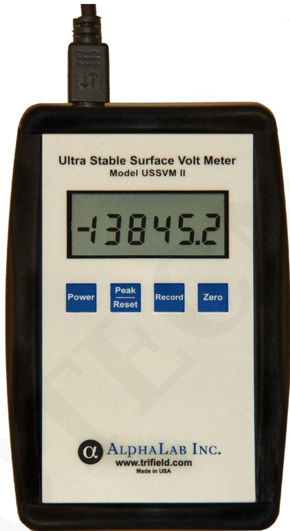
Un medidor electrostático, el USSVM2 lee electricidad estática sin contacto. Mide el voltaje en las superficies y se puede usar para calcular la densidad de carga en los aisladores. Tiene retención máxima y una resolución de 1/10 de voltios en un rango de 20K voltios
