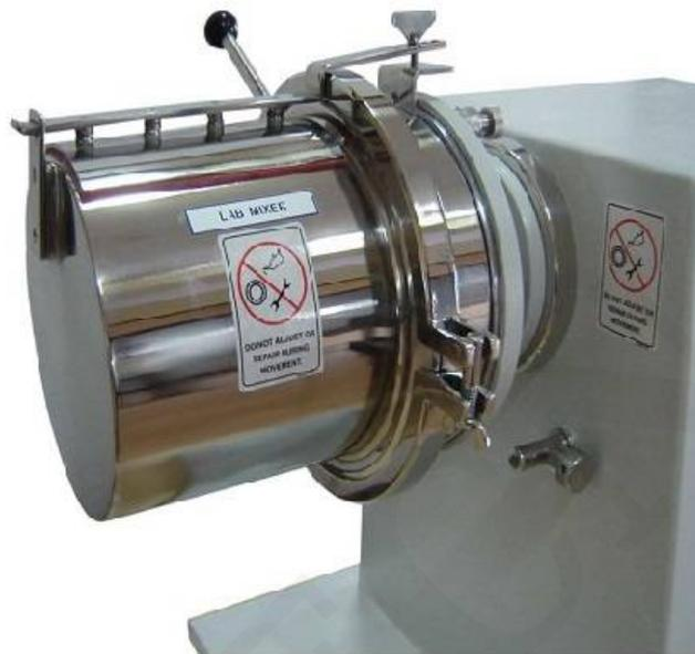
El mezclador de laboratorio funciona con elementos de mezcla en forma de arado y está diseñado para mezclar polvos, granulados y productos que contienen partículas de fibra. Las proporciones de cantidad son hasta 1: 100000 se pueden mezclar homogéneamente en unos pocos minutos.
