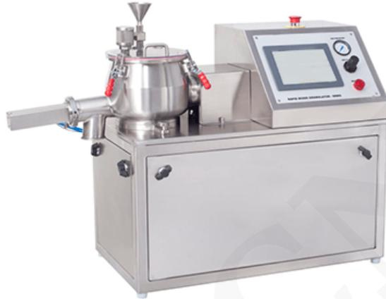
Básicamente, consta de un conjunto de tazón, impulsor y picador. Su estructura principal esta hecha de un solido tubo de acero dulce, y esta cubierta con una protección SS-304.
