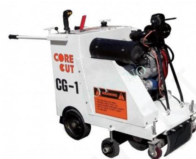
Fácil de usar, máquinas compactas de ranurado y rectificado. Útil para crear áreas con textura antideslizante para una mejor tracción.
