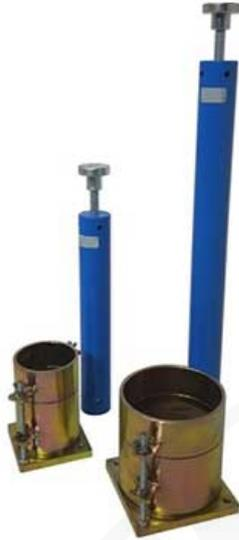
Se utiliza para determinar la relación entre el contenido de humedad y la densidad de los suelos compactados.
