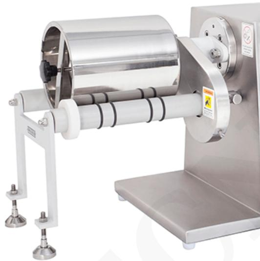
Es un accesorio muy resistente y se utiliza principalmente para moler materiales cristalinos y para mezclar materiales secos. El molino de bolas consta de la transmisión, el soporte y el recipiente de bolas (de acero inoxidable) que varían en diámetro de 30 a 40 mm.
