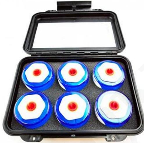
Paquete de 6 controles de sal de calibración para sondas Hygro-i. Diseñado para producir un ambiente de 75% HR dentro de la cámara que puede usarse para asegurar que la calibración de la sonda Hygro-i ® RH sea óptima.
