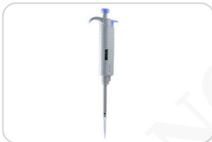
Todas las pipetas han sido probadas según la norma ISO8655-2: 2002 con certificado de calibración. El control de calidad implica pruebas gravimétricas de cada pipeta con agua destilada a 22 °C.
