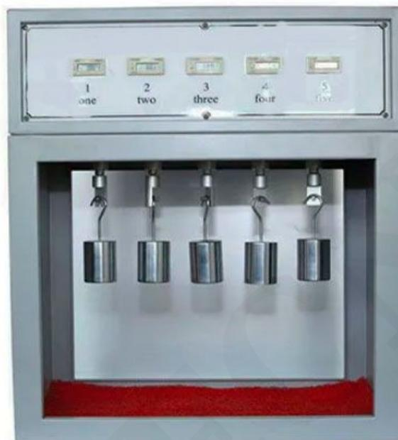
Este equipo se utiliza para realizar una prueba de carga estática para determinar la adherencia de la cinta a fin de evaluar la propiedad de retención mediante la recodificación de la era de remanente o la separación de la cinta por debajo de la carga requerida y la temperatura ambiente. La gama ofrecida se fabrica utilizando material de calidad óptima con la ayuda de tecnología desarrollada y maquinaria moderna para satisfacer las necesidades del cliente.
