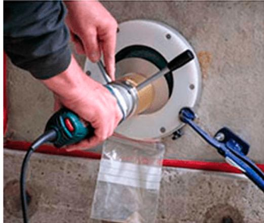
Se utiliza para obtener muestras de polvo de hormigón mediante molienda de precisión en pequeños incrementos de profundidad para la determinación precisa del perfil de iones de cloruro
