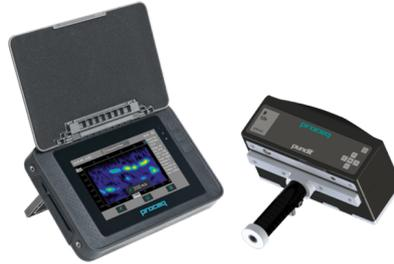
El Pundit 250 Array es un escáner de imágenes de eco de impulsos ultrasónicos que se puede utilizar para el escaneo profundo de hormigón y concreto reforzado con fibra. Se puede usar para mediciones de espesores de concreto grueso y revestimientos de túneles; determinar defectos localizados tales como vacíos, panalización y profundidad y extensión de delaminaciones y la detección de objetos en el concreto tales como tuberías y conductos de tendón más allá de la capa de varillas corrugadas.
