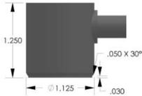
R30I-AST - Sensor AE preamplificador integral de 300 kHz
