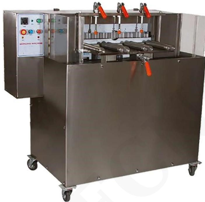
La rectificadora automática se está convirtiendo rápidamente en la alternativa elegida al método tradicional de recubrimiento de caucho o azufre utilizado por laboratorios de construcción de calidad.
