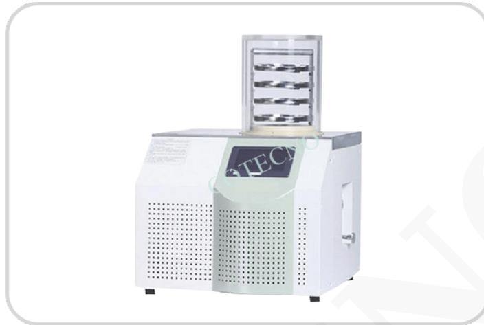
La secadora por congelación de laboratorio es adecuada para la prueba de liofilización de muestras biomédicas de laboratorio.
