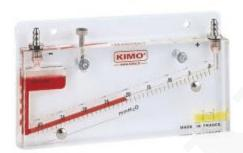
Las series MG de Kimo son manómetros de columna líquida inclinados con líquido manómetro AWS.10 con una densidad de 0,87.
