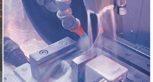
Enfriamiento y filtración eficiente de muestras
