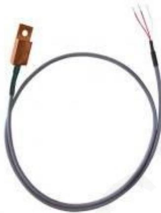
La SFCS 50 / SFCSD 50 de Kimo es una sonda de temperatura con una punta de cobre para contacto con la superficie. Es adecuado para todos los sectores y tiene un rango de medición de -50 a + 400 ° C (PT100 y PT1000) y de -20 a + 120 ° C (NTC).
