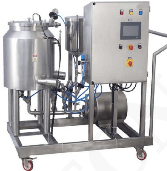
El sistema CIP es útil para limpiar y lavar en el lugar del recipiente, tanque, contenedor, equipo de lecho fluido, mezclador de alto cizallamiento, licuadora, revestidor automático y contenedor IBC
