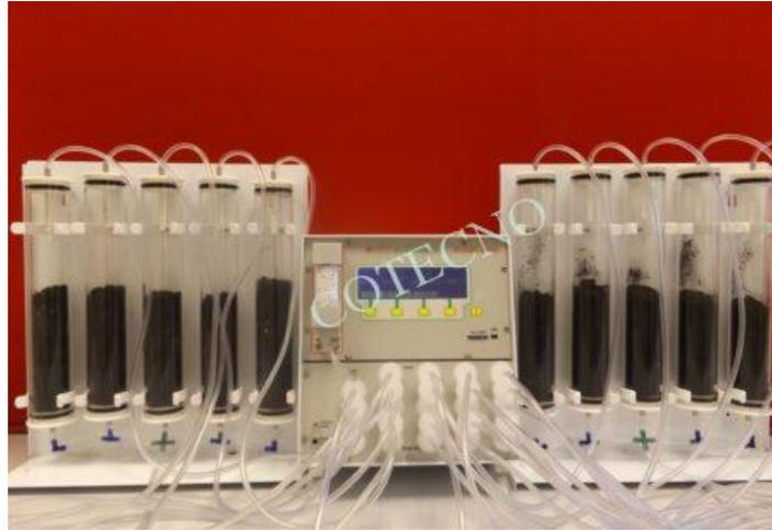
El EGA60 es un sistema de medición de la respiración del suelo multicanal. Un solo sistema EGA60 puede medir hasta 24 muestras de suelo.
