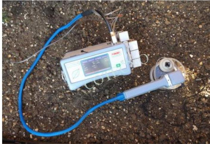
Tanto el CO<sub>2</sub> como el H<sub>2</sub>O pueden controlarse automáticamente dentro de la cámara. Se pueden controlar a concentraciones únicas o automáticamente a niveles secuenciales. Esto permite determinar el flujo del suelo a diferentes concentraciones de CO<sub>2</sub>, mientras que la capacidad de secar el aire dentro de la cámara evita la condensación cuando se trabaja con suelos de alto contenido de humedad.
