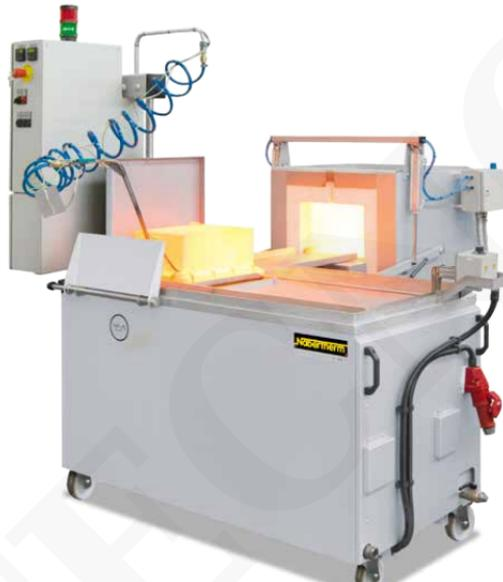
Este sistema semiautomático compacto resulta muy adecuado para templar en una atmósfera gaseosa protectora y, a continuación, enfriar la pieza en aceite o agua.
