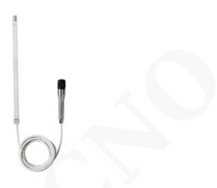
La sonda de higrometría de Kimo es una sonda intercambiable que mide la temperatura y la humedad. Tiene un rango de medición de 5 a 95% de HR y de -40 a + 180 ° C para las sondas de acero inoxidable y de 5 a 95% de HR y de -20 a + 80 ° C para las sondas de policarbonato.
