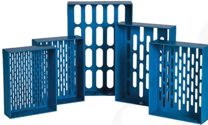
Se utiliza para determinar si el agregado es escamoso; es decir, si el espesor es inferior a 0,6 del tamaño nominal.
