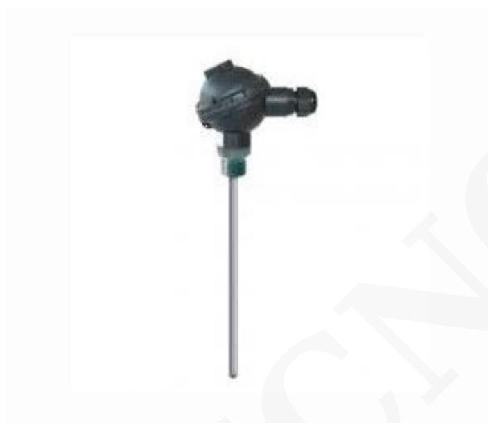
El TP 50 / TPD 50 de Kimo es un sensor de temperatura ideal para las industrias química y alimenticia. Tiene un rango de medición de -80 a + 400 ° C (Pt100 y Pt1000) o de -20 a + 120 ° C (NTC).
